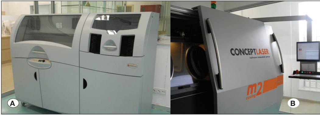
Şekil 6: 3D plastik yazıcı (ZCorp, Zprinter 650) tarafından plastik modeller üretilir (A). Kafatası implantı, SLM teknolojisini (M2 Cusing, Concept Laser GmbH Lichtenfels, Almanya) ve tıbbi Ti-alloy Rematitan'ı (Ti6Al4V, Grade 23 (ELI)) kullanan metal 3D yazıcı ile üretilir (B).
