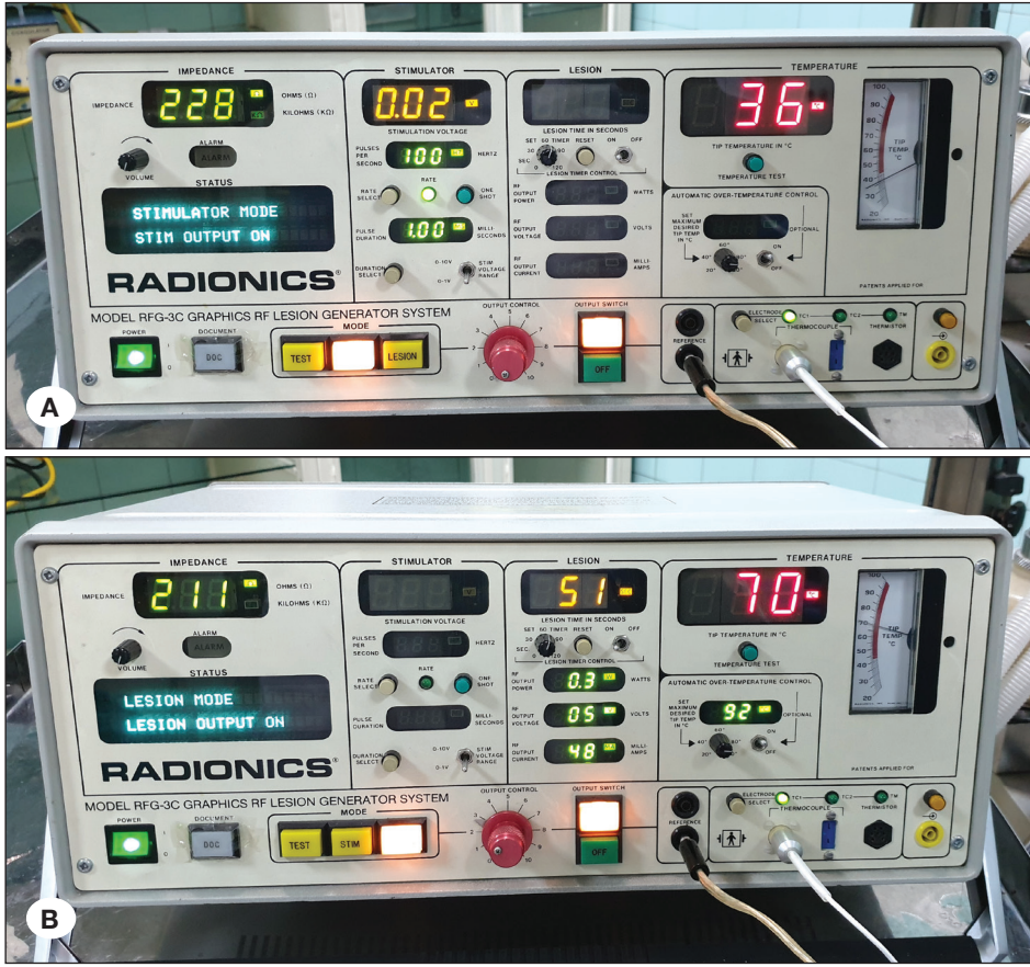
Şekil 6: RF Jeneratörü; A) Stimülasyon sırasında, B) Lezyon oluşturulması sırasında.
