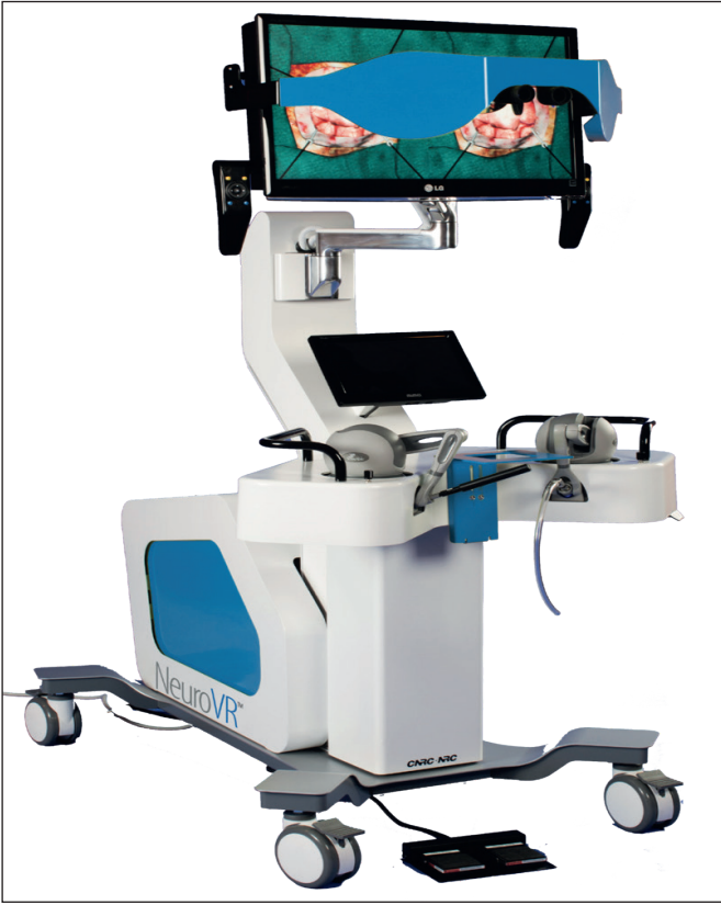
Şekil 3: NeuroTouch (NeuroVR), sanal yumuşak dokunun her iki eldeki bir cerrahi aletle haptik etkileşimine izin veren 2 haptik cihazı barındırır.
