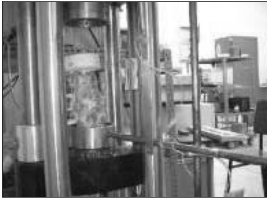
Şekil 3: Rotasyon için rulmanlı düzenekte piyese rotasyon momenti verilmesi
