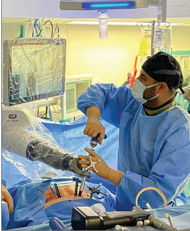
Şekil 5: Cerrahin, planlama ekranındaki anlık navigasyon görüntülerine bakarak, robot kolu vasıtasıyla, navigasyon alıcılı tornavida ile pediküler vida yerleştirmesi.
